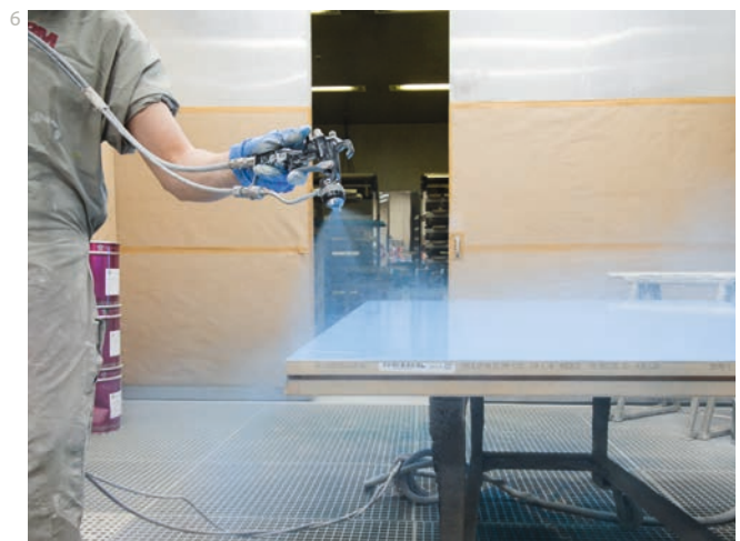
6 – Lackierung Zusätzlich zur automatischen Lackieranlage werden Sonderformate noch von Hand lackiert.
