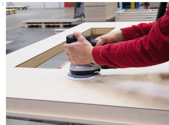
5 – Vor dem Lackieren wird sichergestellt, dass die Oberfläche allen Ansprüchen genügt.
