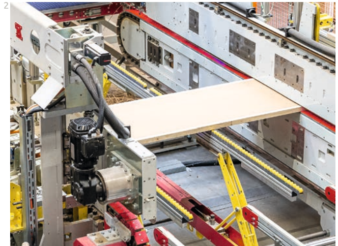
2 – Mittellagenproduktion Die Türeinlagen werden vollautomatisch zugeschnitten und berahmt.
