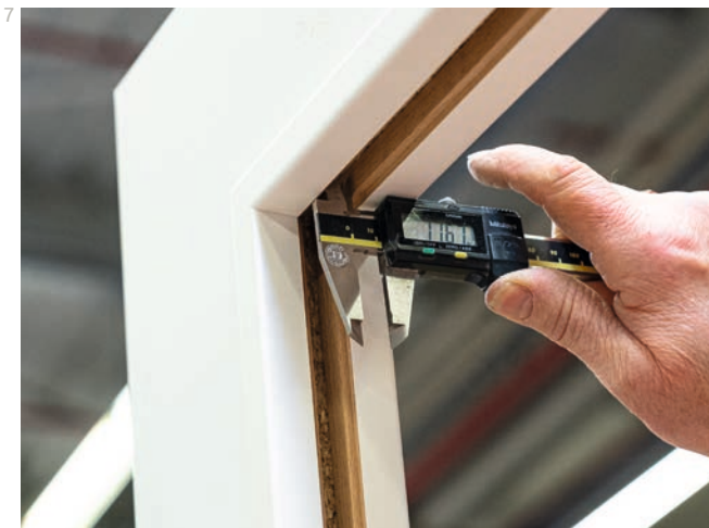
7 – Qualitätskontrolle Vor dem Einglasen werden die Maße überprüft, um für absolute Dichtheit zu sorgen.
