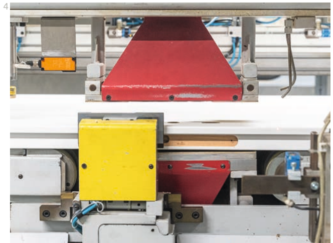
4 – Beschlagsfräse In der Beschlagsstraße werden die Taschen für Schlösser, Bänder und Schließer eingefräst.
