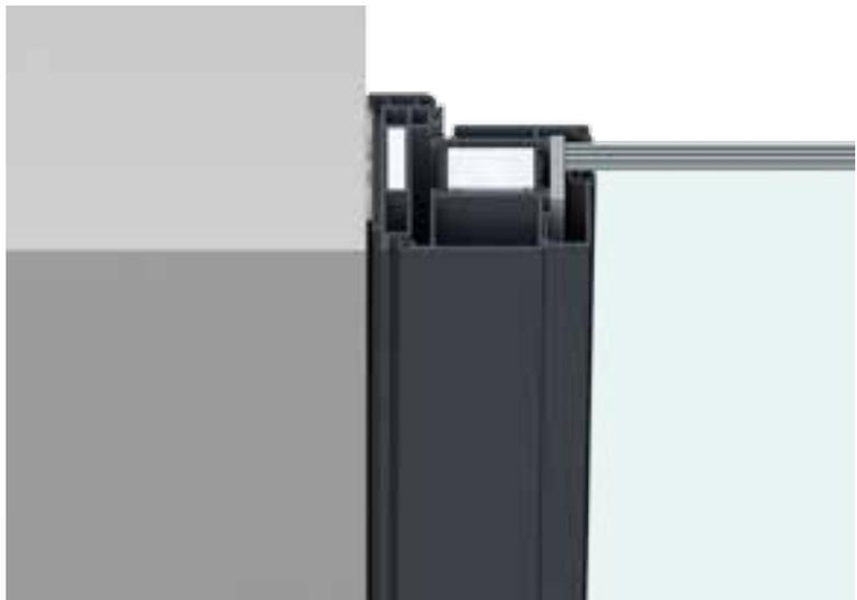
Verglaste Aluminium-Rohrrahmentüren mit spiegelloser Zarge.
